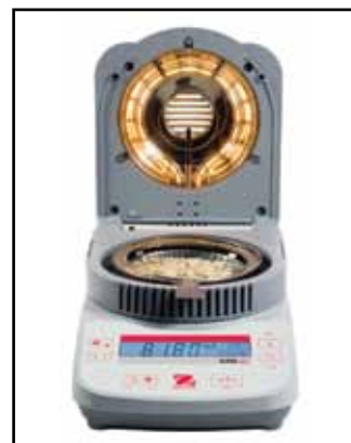
Model OHAUS MB23 se dodává s infračerveným konvenčním ohřevem, dokud MB25 používá halogénovou ohřevu.
